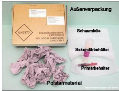
Jedes fertige Versandstück besteht neben den Füllmaterialien aus drei Komponenten:
